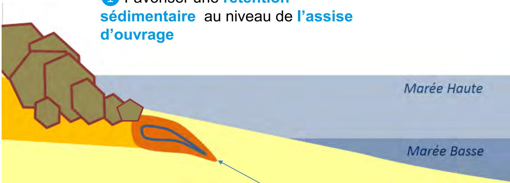
③ sceller les blocs afin **d'augmenter la cohésion** du pied de l'ouvrage
